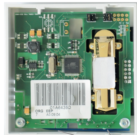
"Learn-painike" (alapuolella) anturin perusyksikköön liittämistä tai rinnankytkentää varten
