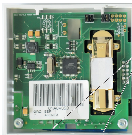
Potentiometrar (2 st) för kalibrering av rH- respektive CO 2 -nivå
