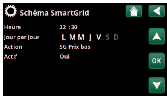
La fonction SmartGrid «SG Prix bas» est programmée en semaine de 22h30 à 06h00. Accédez au menu en sélectionnant «Schéma SmartGrid» dans le menu «Avancé/Réglages».
