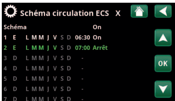
Menu : « Installateur/Réglages/Ballon ECS/Prog boucl ECS ». Dans l'exemple ci-dessus, le « circulation ECS » est activé chaque semaine - du lundi au vendredi entre 06h30 et 07h00.
