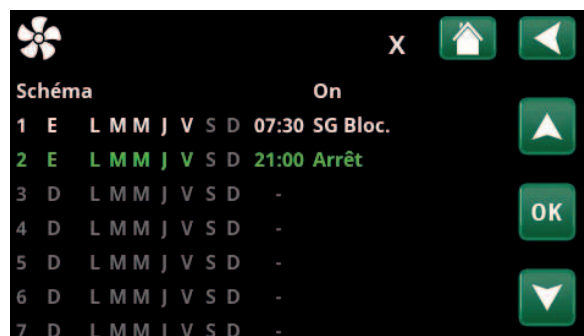
Menu : «Installateur/Réglages/SmartGrid Schéma».
