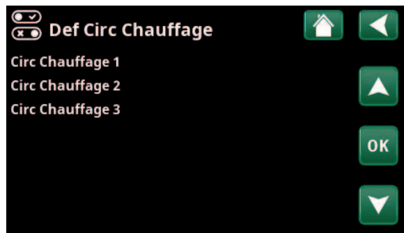
Menu : «Installateur/Définir/Circuit de chauffage». Sélectionnez un circuit de chauffage et appuyez sur «OK» pour accéder aux réglages.
