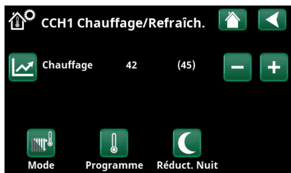
Menu « Installateur/Définir/Circ Chauffage/Circ Chauffage 1 ». Le circuit de chauffage n'a pas de sonde d'ambiance. Le valeur de consigne (température de départ 45 °C) est indiqué entre parenthèses, la température de départ actuelle de 42 °C est indiquée à gauche du point de consigne.
